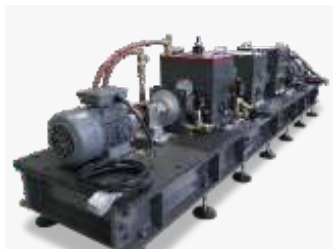
动力传动故障预测实验台
