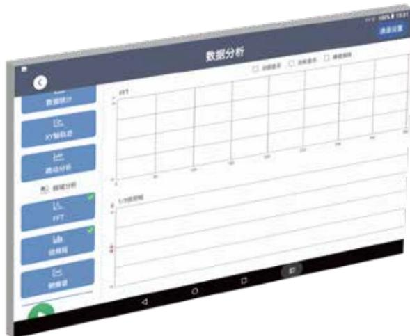
具备多种数据分析功能, 除了做电机马达异响检测以外, 还可以做振动、声音的监测及分析
