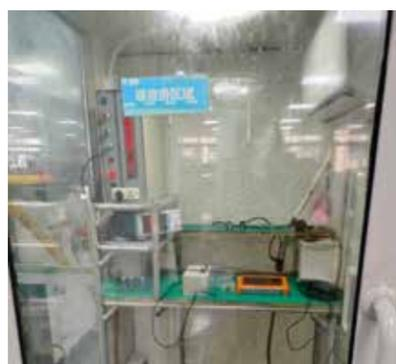
在工厂内部, 用真空隔音玻璃打造一个消音室, 然后通过人工通电开机, 采集不同转速下的声音数据, 超过合理阈值即可声光报警。
