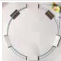
使用玻璃纤维 (GFRP) 材料封装
